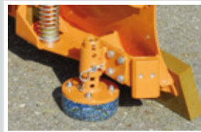
Höhenverstellbare Gleitpflanz-Garnitur Height-adjustable set of gliding devices Jeu de patins réglables en hauteur
